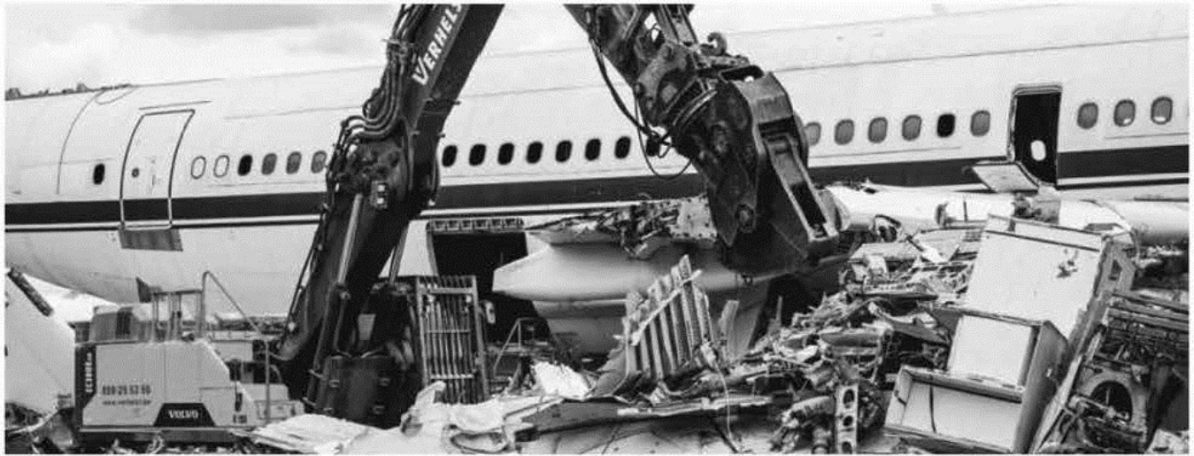
圖3 回收過程之拆解示意圖
