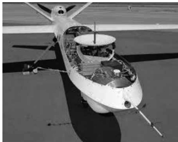
圖4 大型無人機機頭裝置的碟形衛星天線
