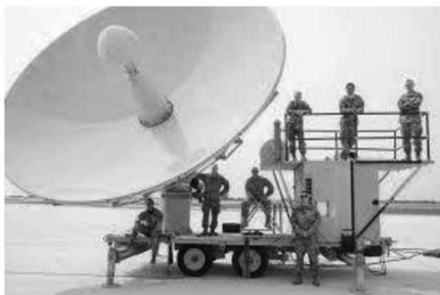
圖3 大型無人機地面控制站的衛星通訊設備
